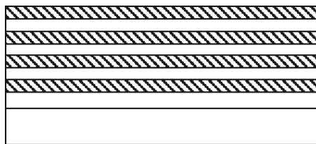
图 1 高射频磁导率的多层电磁干扰屏蔽薄膜 [10]
